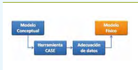
Figura 4. Secuencia para la generación de una base de datos relacional partiendo del modelo CIM.
